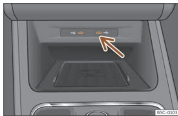
Fig. 163 Centre console: USB input.
