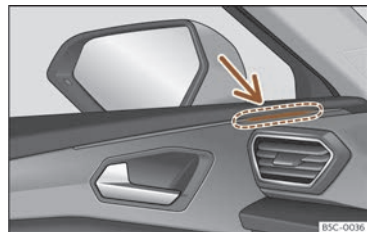
Fig. 159 Door: warning lamp
