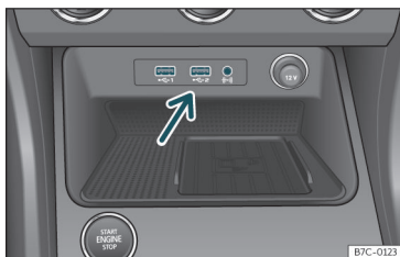
Fig. 191 Centre console: USB/AUX-IN input.
